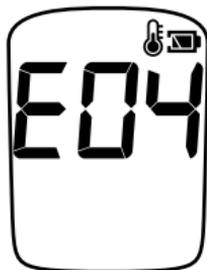
Температура окружающей среды выше или ниже рабочей температуры системы. Рабочая температура системы от 10 до 40°C. Повторите тест после достижения глюкометром нужного температурного диапазона.
