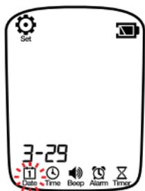
Когда глюкометр выключен, чтобы войти в режим настройки, нажмите и удерживайте кнопку «power» 2 секунды. В нижней части экрана появятся установки Date (Дата), Time (Время), Beep (звуковой сигнал), Alarm (Сигнал тревоги) и Timer (Таймер).
