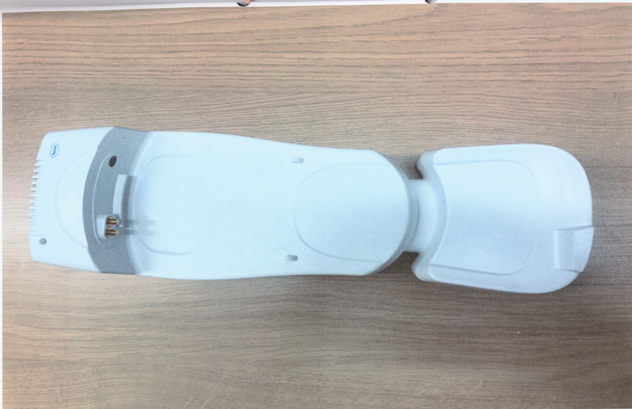
Принадлежности: 1. Портативный базовый блок (док-станция) для передачи данных по локальной сети или по USB (Handheld Base Unit) в составе:
