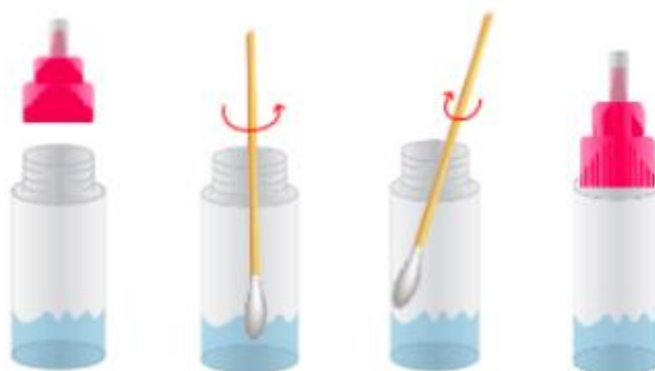
Рисунок 5. Процедура растворения образца в буферном растворе.
